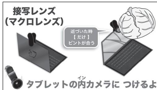
図2 タブレットの内カメラに接写レンズをつける
