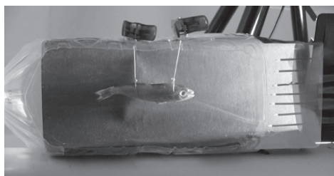
▶図2：ペットボトルの真ん中にムツをひもで吊るして洗濯バサミで固定し、頭の方から線香の煙を流し、掃除機で吸うと、断片的に滑らかな流れが観察できる。背面に黒画用紙を使うなど工夫。 https://youtu.be/qAmiww_XsNU
