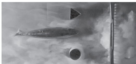
▶図2：ペットボトルの真ん中にムツをひもで吊るして洗濯バサミで固定し、頭の方から線香の煙を流し、掃除機で吸うと、断片的に滑らかな流れが観察できる。背面に黒画用紙を使うなど工夫。 https://youtu.be/qAmiww_XsNU
