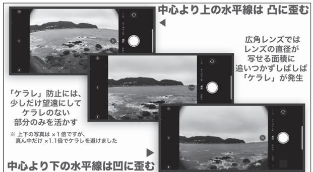
▶ワイドレンズの一般的なくせ。中心より上の水平線は凸に歪み、中心より下の水平線は凹に歪む。
