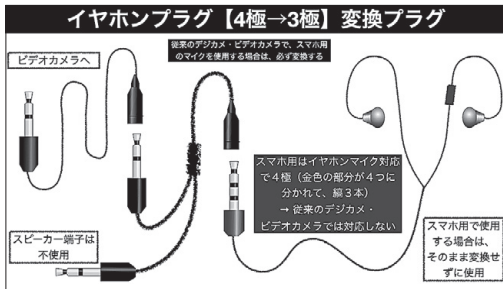
▲スマホ用のイヤホンマイクを、変換プラグ、延長ケーブルを使用して、ビデオカメラへつなぐ図。
