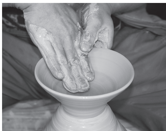
▲ロクロの回転と遠心力で作られる \bigcirc の器 (川本太郎・皿屋、佐賀県)
